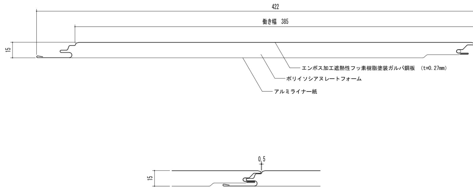
ガルバ鋼板は55%アルミニウム-亜鉛合金めっき鋼板でアイジー工業（株）の登録商標です。
