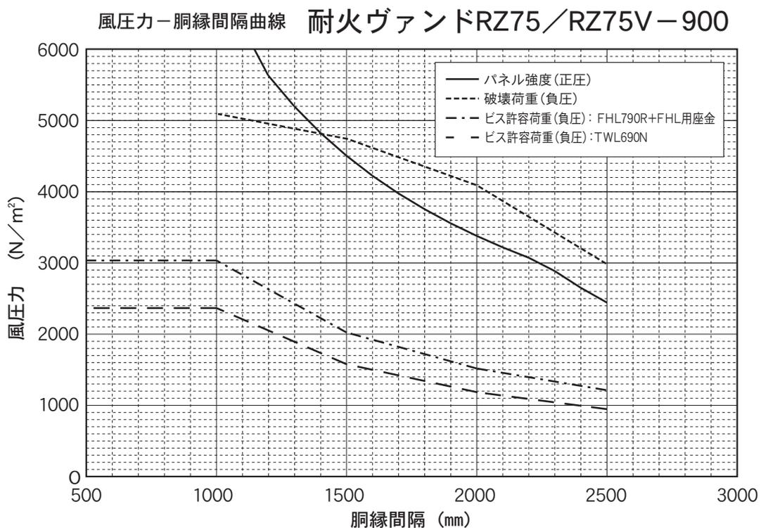
注) 破壊荷重は風圧力試験での測定値です。
