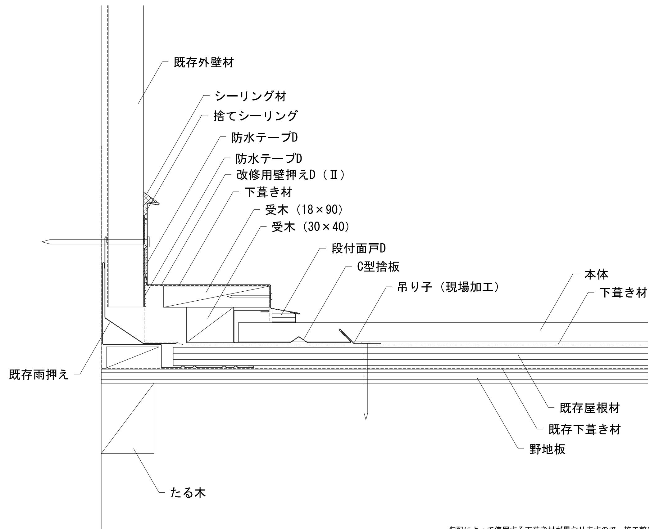
・勾配によって使用する下葺き材が異なりますので、施工前に下葺き材の種類を確認してください。
