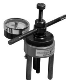
引張荷重測定器（例） サンコーテクノ株式会社 テクノテスターKT-6
