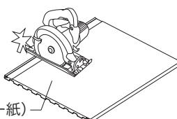
開口部などで本体を切り欠いて施工する場合は、本体を変形させるような無理なはめ込みはさけてください。しん材や裏面材が破損した本体は使用しないでください。時間の経過とともに表面の変形が大きくなるおそれがあります。
