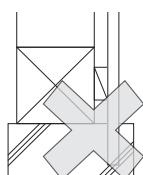
土台部や縦継ぎ部等で本体の端部をあらわしで納める際は、しん材の吸水を防ぐため、本体の下部からしん材を10mm程度取り除いてください。
