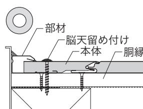
本体を切り欠き加工すると強度が低下して破損しやすくなります。本体を切り欠いて使用する場合は、本体がゆがまないように、切り欠いた部分に補強材（面材など）を当てて運搬してください。また、しん材や裏面材が破損した本体は使用しないでください。
