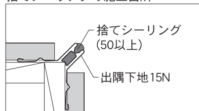
捨てシーリングの施工箇所
