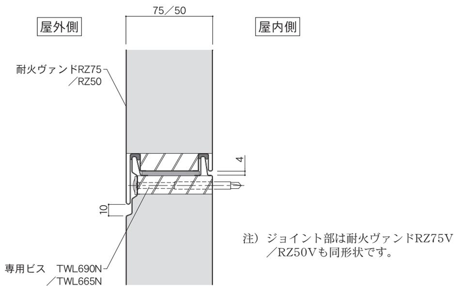
**【注意 !!】** パネル強度を確保するために本体取り付け用ビスは必ず専用ビスを使用してください。
