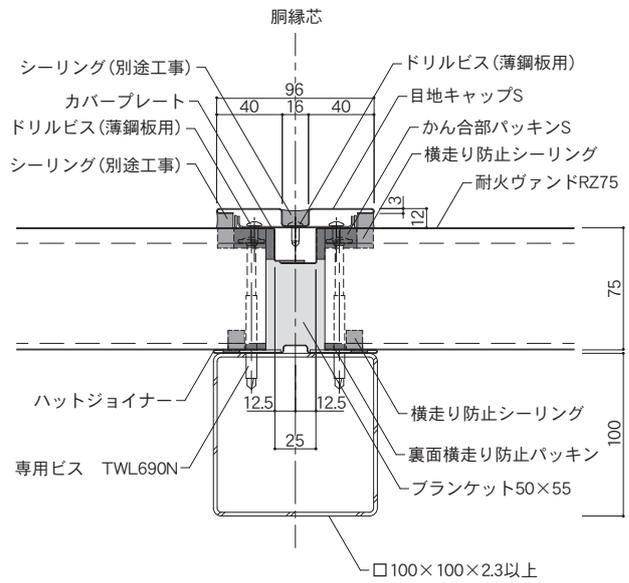
※シーリングタイプのたて目地幅はパネル長さで設定してください。目地幅の設定はP132を参照してください。
