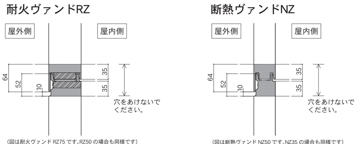
**【注意 !!】** パネル施工後にかん合部に穴をあけると横走り防止シーリングなど十分な防水処理ができないため漏水する可能性があります。上記寸法の範囲内（
