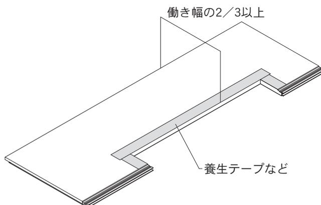
・ 欠き込んだ残りの幅が、働き幅の2/3以上となるようにしてください。
