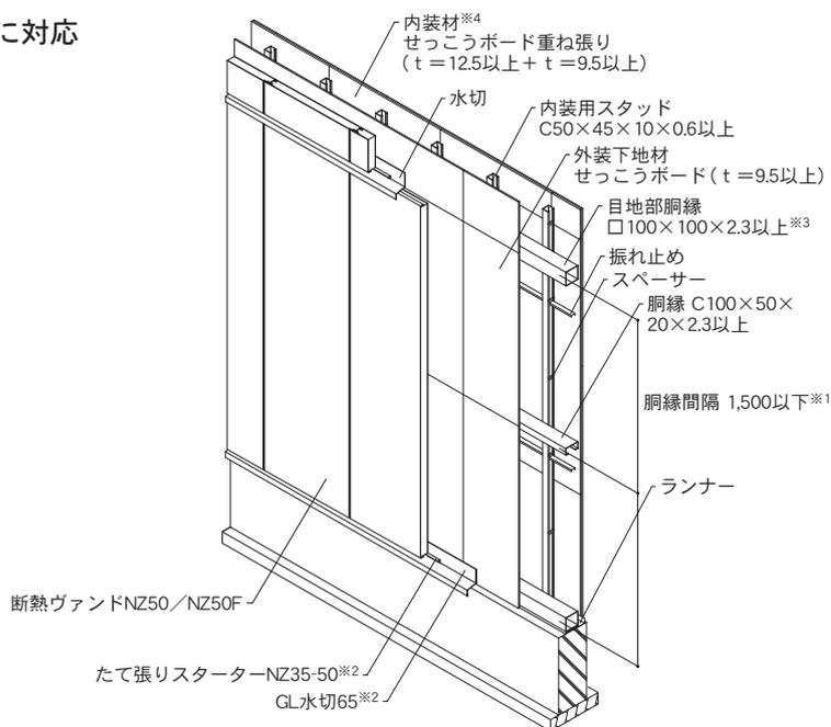
・外装下地材はドリルビス（φ3×L20以上）を用いて500mm以下の間隔で胴縁に留め付けてください。
